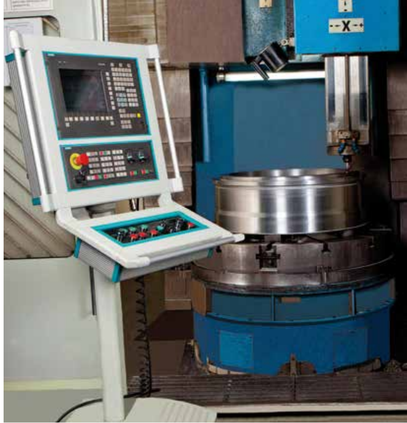
Rohlingsbearbeitung auf der CNC-Drehmaschine Blank machining on a CNC lathe
